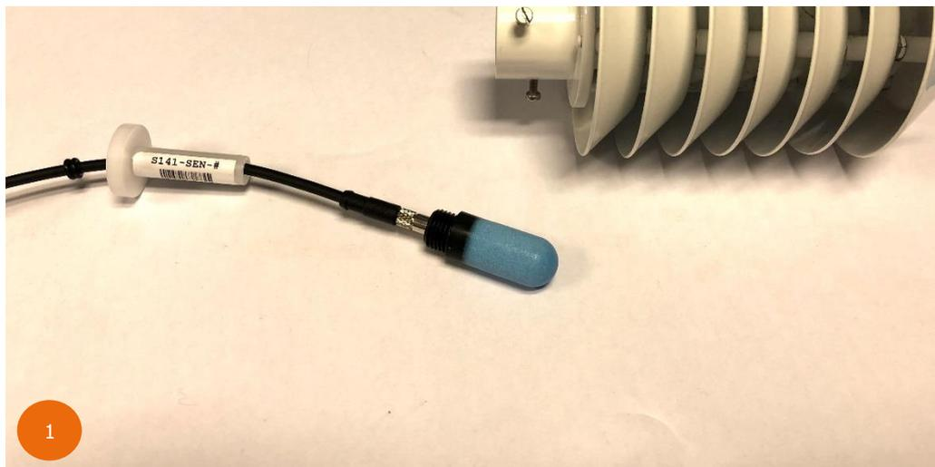
ÉTAPE 2 : Dévisser le support métallique afin de retirer le capteur du câble
