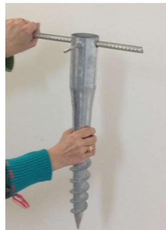
ÉTAPE 2 : Visser la vis d'ancrage dans le sol, tout en appuyant sur la barre de rotation avec une main de chaque côté
