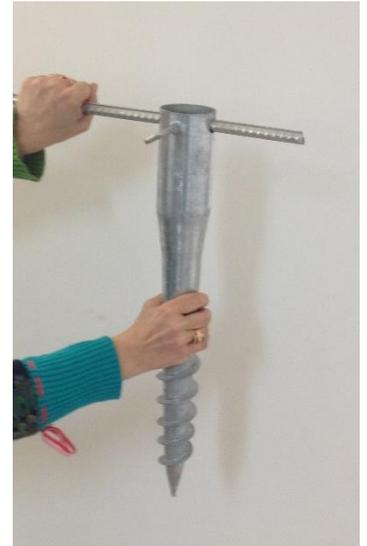
ÉTAPE 2 : visser la vis d'ancrage dans le sol, tout en appuyant sur la barre de rotation avec une main de chaque côté
