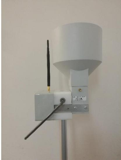
ÉTAPE 3 : vérifier l'horizontalité du bloc pluviomètre à l'aide de son niveau à bulle
