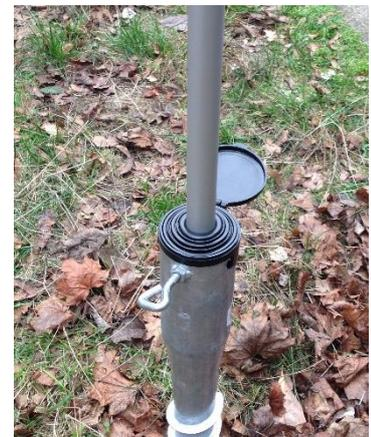
ÉTAPE 6 : vérifier la verticalité du pied avec un niveau ou à l'aide du niveau à bulle du bloc pluviomètre
