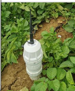
La gamme Météus s'enrichit également d'une sonde capacitive. Cette sonde vous permettra de déclencher votre irrigation au bon moment. Implantée au cœur de vos parcelles, la sonde mesure l'humidité dans le sol et vous
